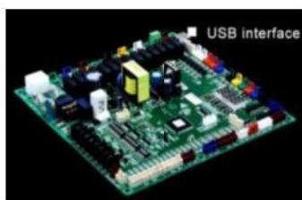
کنترل پیشرفته جهت جمع آوری اطلاعات سنسورها و سوئیچ های مختلف و کنترل بهینه اجزا دستگاه، دارای کنترل فاز داخلی، کنترل جریان، درگاه BMS ورودی USB جهت خدمات و رابط کاربری جامع و آسان
